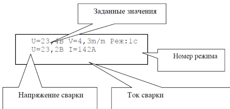
Рис. 2. Вид дисплея при сварке
