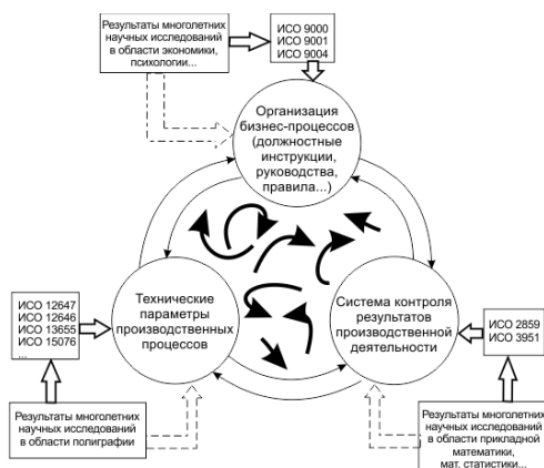
Рис. 2. Схема взаимосвязи стандартов менеджмента качества, выборочного контроля и отраслевых стандартов и процессы, происходящие в их рамках
