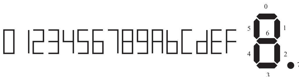
Рис. 2. Формирование цифровых символов семисегментного кода
