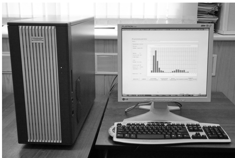
Рис. 1. Сканирующий фотоседиментограф СФ-2М конструкции кафедры «Оборудование и автоматизация силикатных производств», УрФУ
