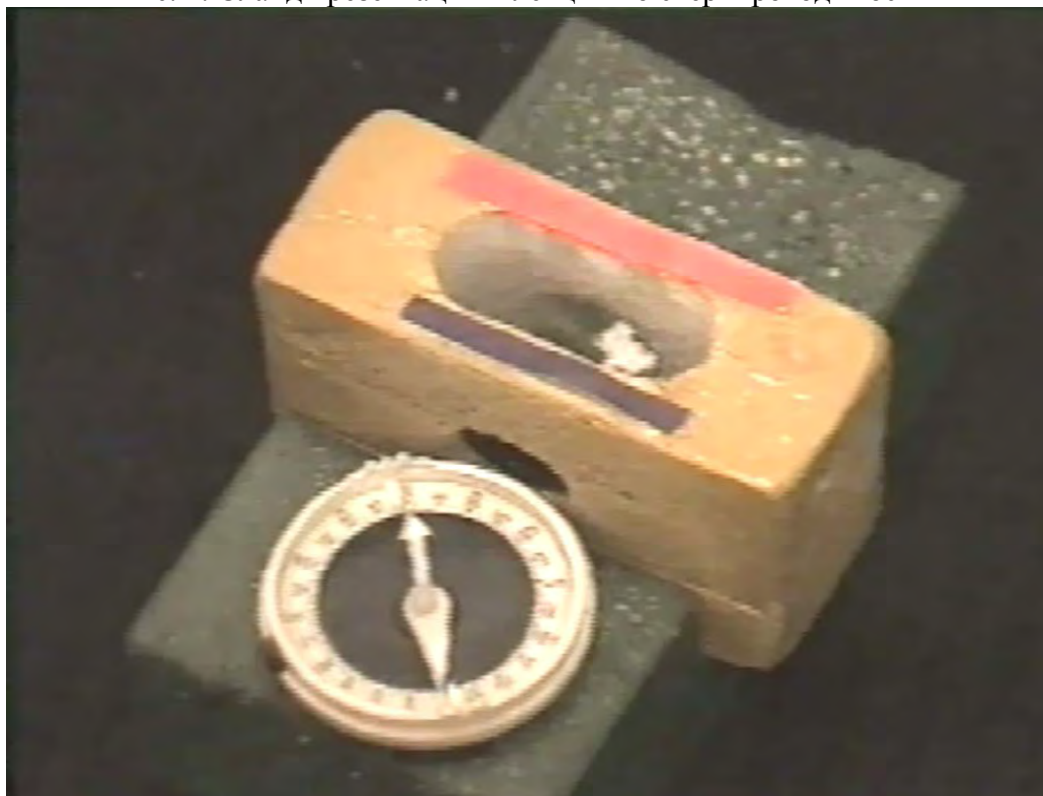
Рис. 5. Фрагмент видеосъемки, демонстрирующий захват магнитного поля сверхпроводящим цилиндром
