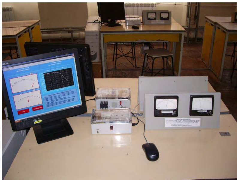
Рис. 3. Установка для выполнения лабораторной работы по определению удельного заряда электрона. Магнетрон – в центре стола в прозрачной коробке с АЦП-преобразователями токовых сигналов; компьютер – в режиме виртуального прибора с аналоговым, цифровым и графическим представлением результатов измерений
