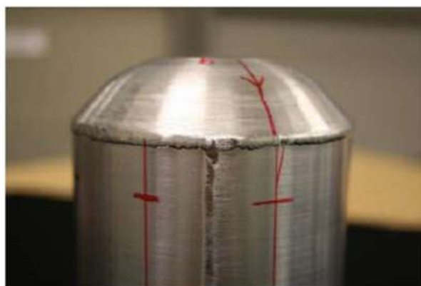
Рис. 3. Внешний вид иридиевого тигля с бесшовным дном, полученного ротационной вытяжкой
