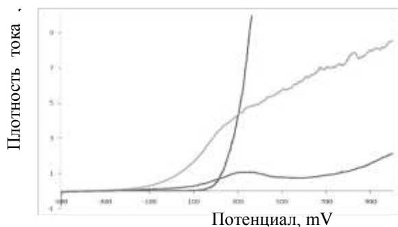
Рис. 4. Кривые анодной поляризации стали в 3,5 %-NaCl: а – после закалки от 1100 °С в воде, б – после закалки и старения при 500 °С; в – после закалки и
