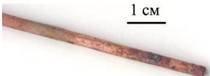
Рисунок 4. Медный анод после электролиза
