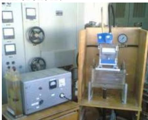
Рис. 1. Установка для электролитно-плазменной обработки металлической поверхности
