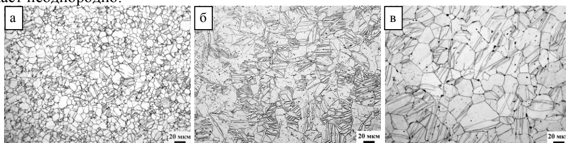
Рис. 2. Микроструктура титана ВТ1-0 после прокатки на 10%: а) d=7 мкм; б) d=15 мкм; в) 30 мкм.
