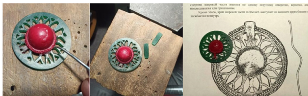
Рис.4. Процесс моделирования по воску
