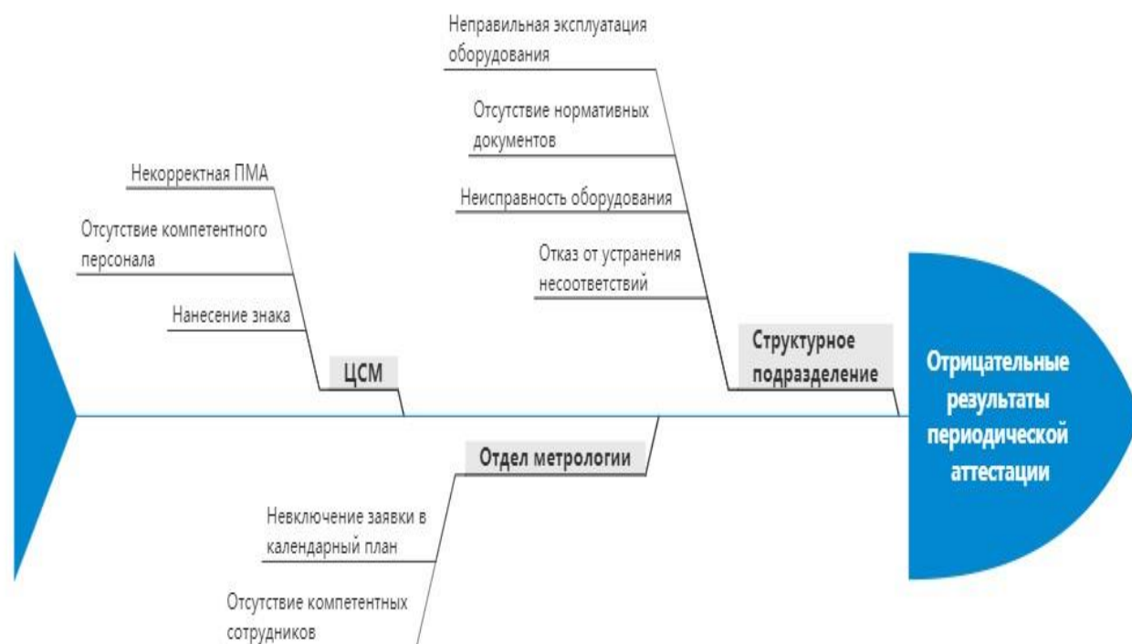
Рис. 1. Анализ причинно-следственных связей процесса аттестации испытательного оборудования
