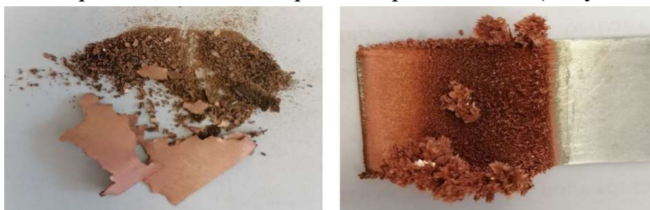
Рисунок 5 – Катодная медь после электроэкстракции
